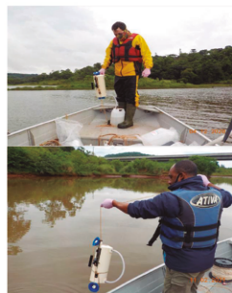
Procedimento de coleta para análise da qualidade da água.
